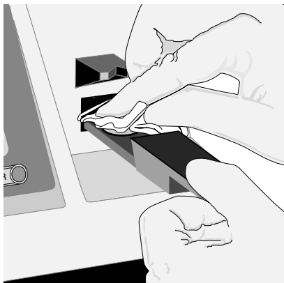
Retirer l'échantillon et nettoyer le support d'échantillon.
