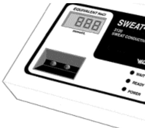
**5** 1 Collegare uno spezzone pulito di tubo a fori microscopici (SS-044) ad uno dei nippoli in acciaio inossidabile ed usarlo come tubo di uscita. Sebbene entrambi i nippoli possano essere utilizzati indifferentemente, per l'uscita si consiglia di usare quello di destra.
