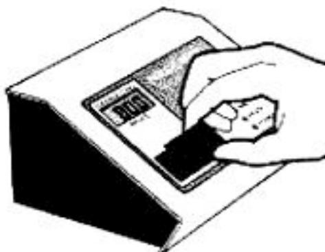
Verificar que as entradas da nova célula de condutividade ficam alinhadas de forma precisa com os orifícios da tampa antes de instalar a célula no Aparelho. Colocar a placa de circuito impresso com os alicates de ponta fina. Colocar a célula de modo que o conector ligue adequadamente com as pontas que sobressaem do conector da placa dentro do Aparelho. Empurrar suavemente a célula até que fique fixada contra o conector.
