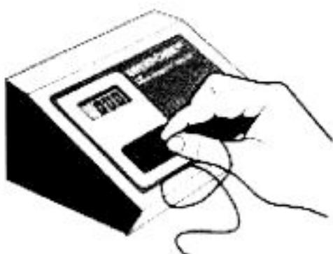
a. Ligar um tubo novo de “captação” (Wescor ref. SS-044) à entrada de saída da célula (pode usar-se qualquer entrada).
