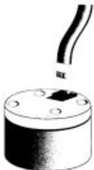
Cabeçal do Termopar e Conector
