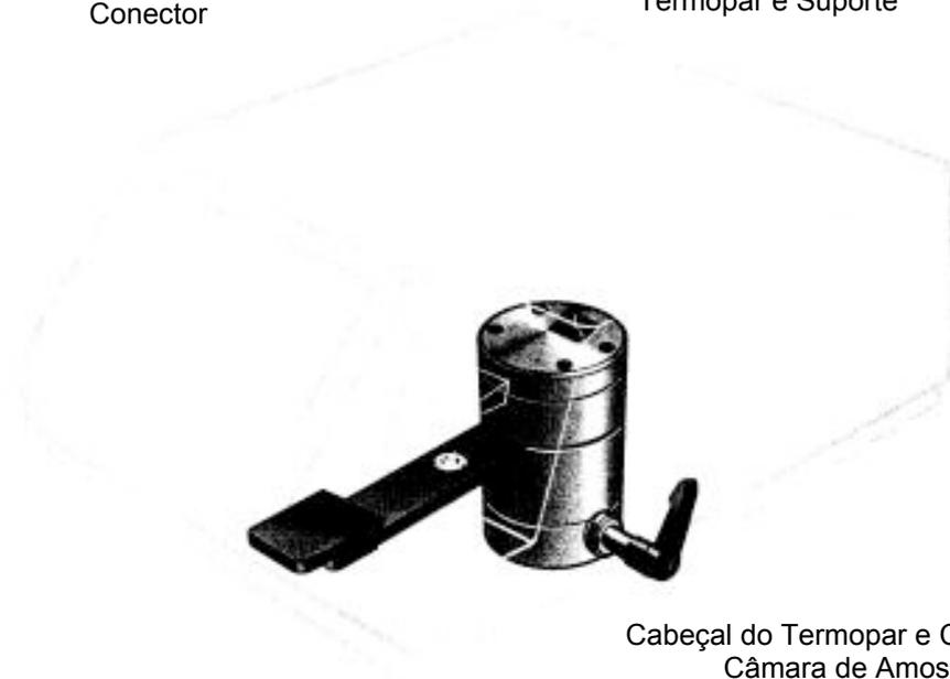
Cabeçal do Termopar e Conjunto da Câmara de Amostras
