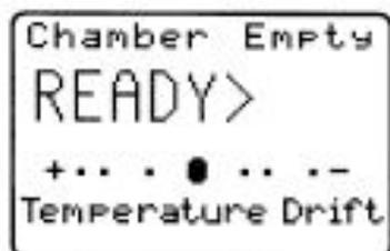
Ainda que o aparelho compense as pequenas mudanças produzidas com o tempo, o movimento do aparelho para uma zona diferente ou, a sua exposição a uma grande circulação de ar pode deslocar os pontos de leitura e calibração do osmómetro. A escala de Flutuação da Temperatura permite determinar o momento em que foi estabilizada a temperatura interna.
