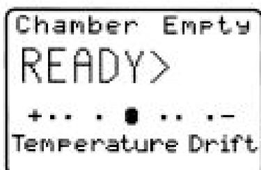
No modo de espera (standby), o osmómetro Vapro não está inactivo. Continuamente monitoriza a sua temperatura operativa interna e a compensa conforme as mudanças da temperatura ambiente que de forma diferente poderiam produzir desajustes da calibração. Também mantém um equilíbrio contínuo nos seus circuitos de controlo do termopar para assegurar a convergência do termopar à temperatura precisa do ponto de condensação durante o ciclo de medição.
