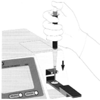
4. Positionieren Sie die Pipettenspitze in der Kerbe der Pipettenführung etwa 5 mm oberhalb des Zentrums der Papierscheibe.
