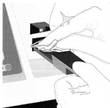
Entfernen Sie die Probe und reinigen Sie den Probenhalter
