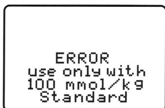
Wenn Sie den TE- Test mit dem richtigen Standard durchführen, und wenn die Bildschirmanzeige die Fehlermeldung „ERROR use only with 100 mmol/kg Standard“ trotzdem anzeigt, kann es sein, daß die Schrauben des Messkopfes nicht fest genug angezogen wurden.
