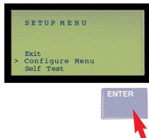
Il Menù di Setup vi permette di scegliere il linguaggio del display, di visualizzare o nascondere il display con i risultati del test, o di eseguire un autotest dello strumento.
