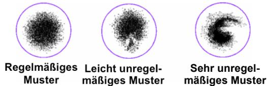
1. Die Düsenöffnung mit Methanol oder Ethanol abwischen, dann den Reinigungszyklus mit der Taste CLEAN starten.
